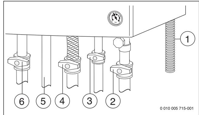
Рис. 1 Подключения газопровода и водяного контура (дополнительная комплектация)
